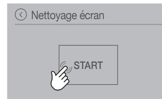
Appuyer sur « START » : un compte-à-rebours démarre, le signal sonore BIP indique que l'écran est inactif et il est possible de procéder au nettoyage sans interférer avec ses fonctionnalités.
