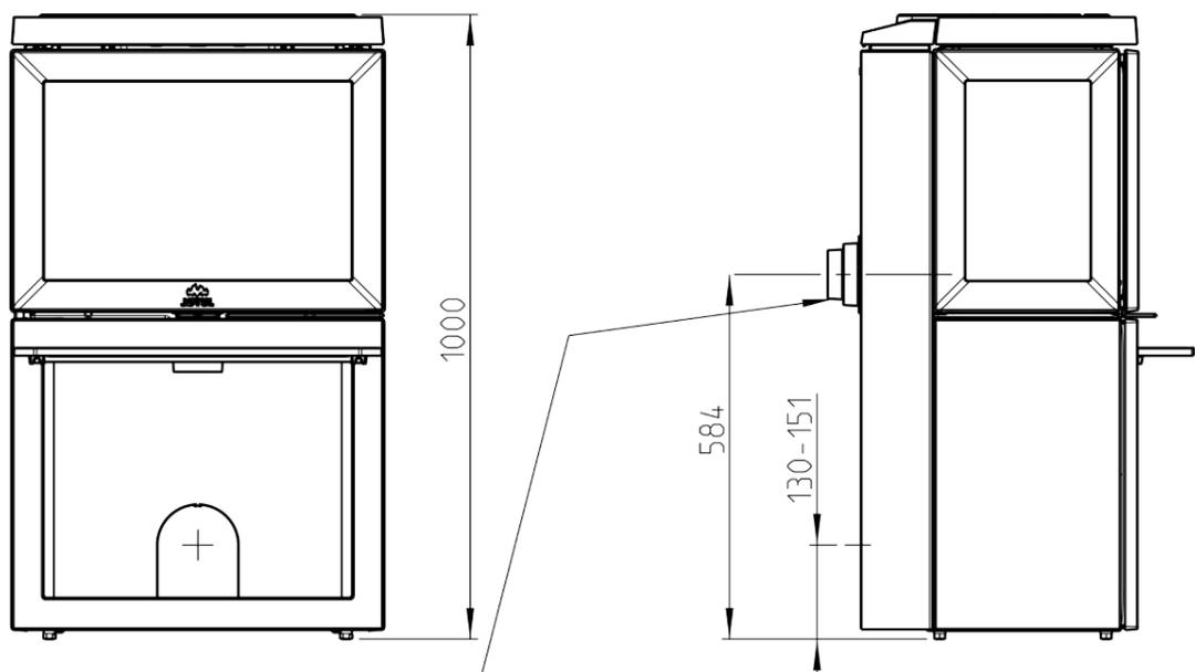
Trou dans le mur pour l'arrivée d'air extérieur  $\varnothing 80/\varnothing 100$
